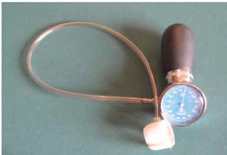
**Figure 43.** Brassard pour mesure de la pression digitale.
